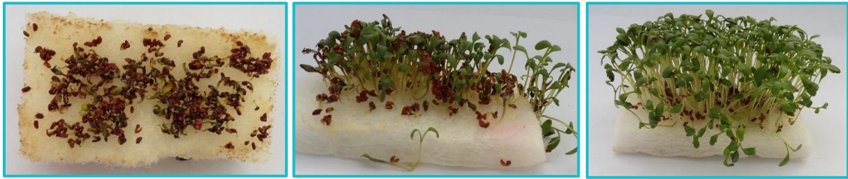
Figuur 9: Kiemtest op textiel gemodificeerd met verschillende hoeveelheden super absorberend textiel.
